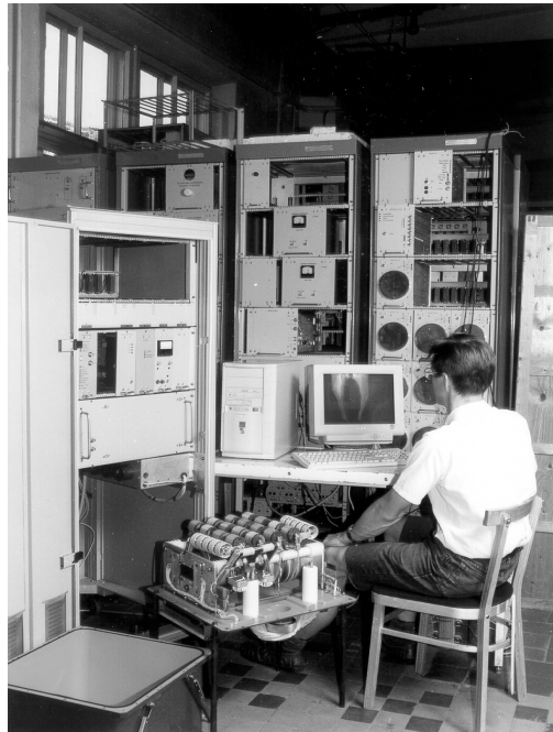
Рис. 3. Рентгеновское питающее устройство в процессе наладки.
