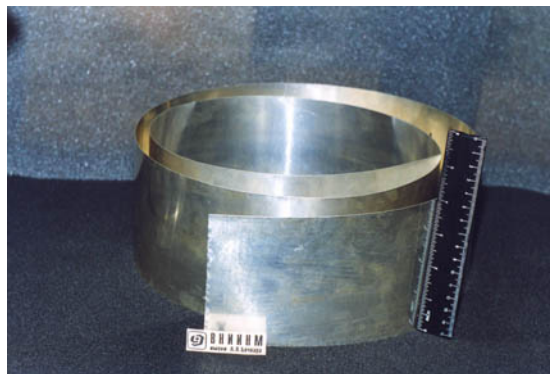
Рис. 5. Листовой композиционный материал на основе соединения Bi-2223 (ГНЦ РФ ВНИИНМ).
