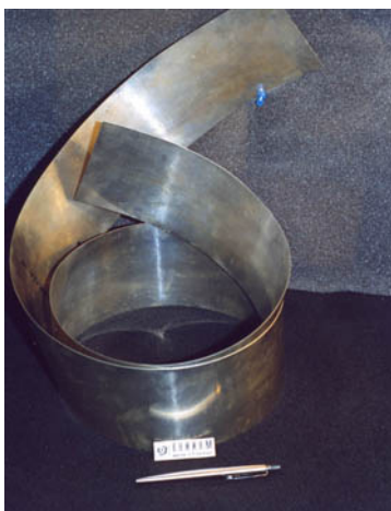
Рис. 5. Листовой композиционный материал на основе соединения Bi-2223 (ГНЦ РФ ВНИИНМ).
