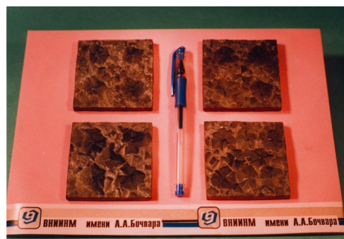
Рис. 6. Массивная ВТСП-керамика YBaCuO, изготовленная методом направленной кристаллизации (ГНЦ РФ ВНИИНМ).
