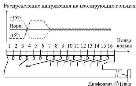
Рис.11. Оптимизация пучка ю путем перераспределения напряжения вдоль ускоряющей трубки (500 кВ)
