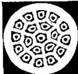
Проводники с крупным поперечным сечением диаметром 1 мм на основе Bi-2223
