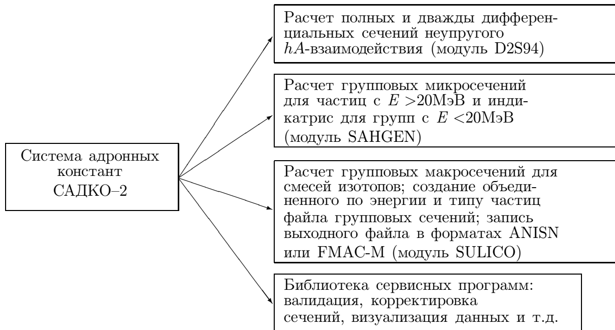
Рис. 5. Схема системы констант САДКО-2.
