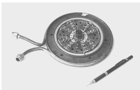
Рис. 12. Общий вид переключателя на pin-диодах.
