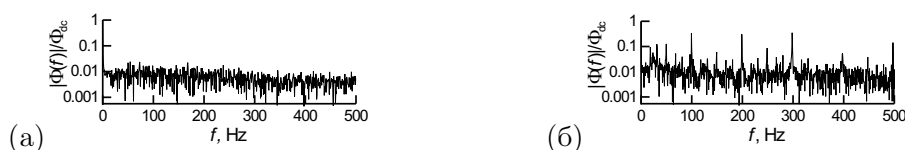
Рис. 22. Амплитудные спектры пульсаций при стохастическом (а) и обычном (б) медленном выводе. Сбросы показаны на рис. 21.
