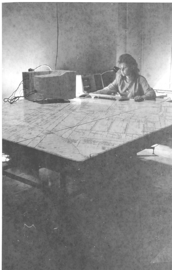
Рис. 3. Рабочее место (фото) оператора проектора ПУОС-4, включая стол-экран, компьютер и средства диалога оператора с компьютером.
