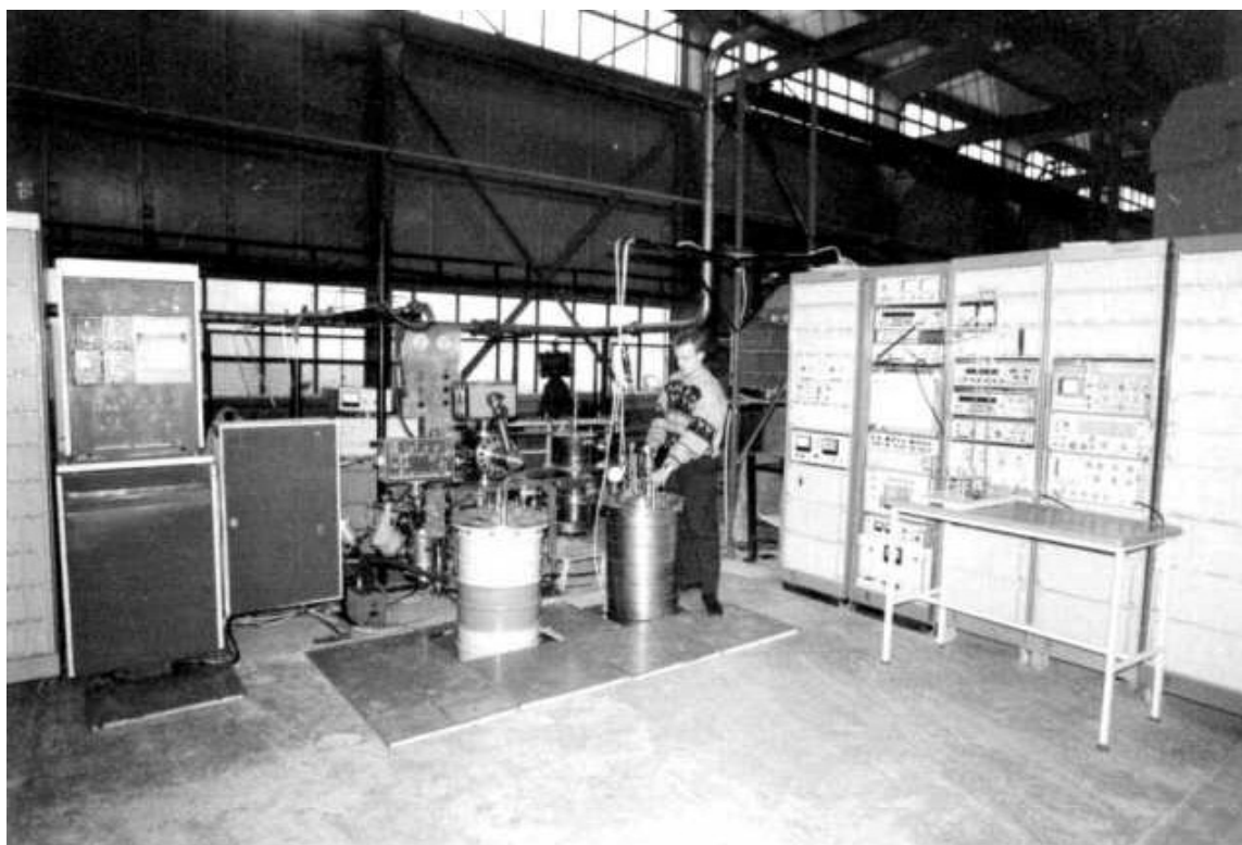
Рис. 1. Внешний вид стенда измерения электрофизических параметров сверхпроводящих ускоряющих резонаторов.
