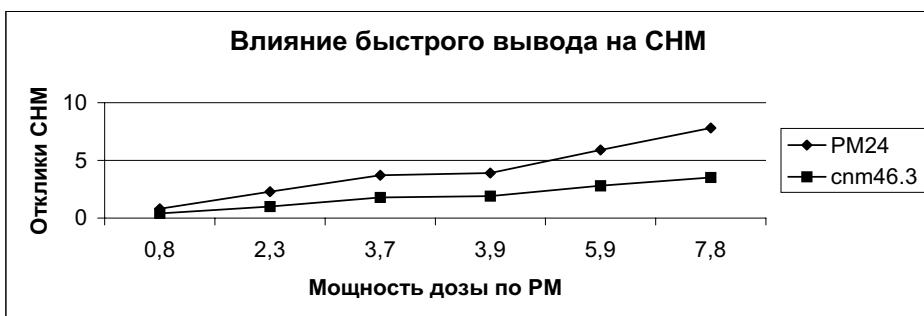
Рис. 7. Отклики детекторов РМ и БДН на быстрый вывод пучка протонов из ускорителя У-70 (PM24 — радиационный монитор АСРК, cnm46.3 — счетчик СНМО3).
