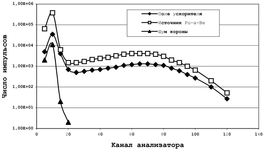
Рис. 5. Амплитудные спектры детектора нейтронов CHM-14 в нейтронном поле  $Pu - a - Be$ -источника, за защищой ускорителя и шумы короны.
