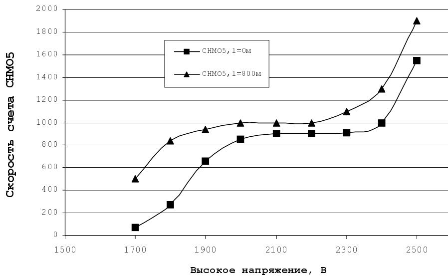
Рис. 4. Счетная характеристика счетчика CHM05 в зависимости от длины кабеля (0,800 м).
