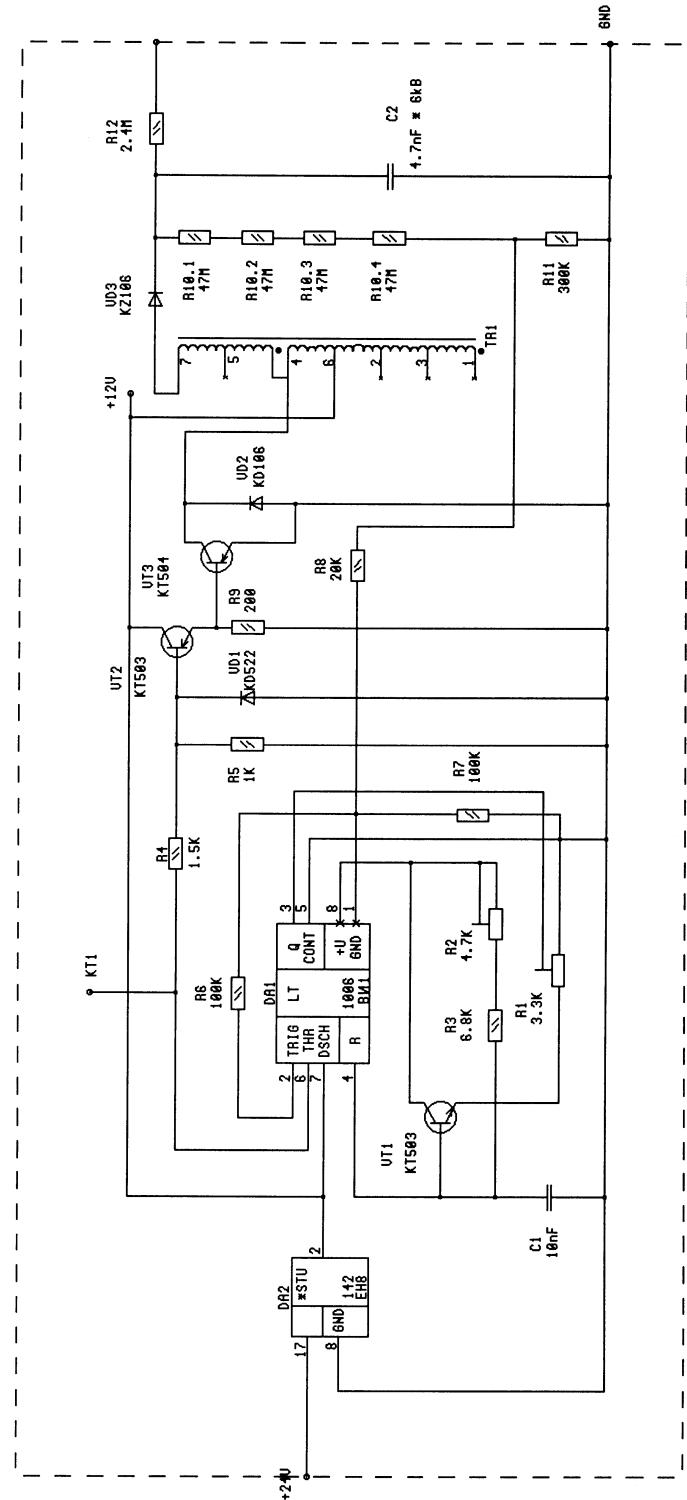
Принципиальная электрическая схема высоковольтного преобразователя 12 В/2500 В.
