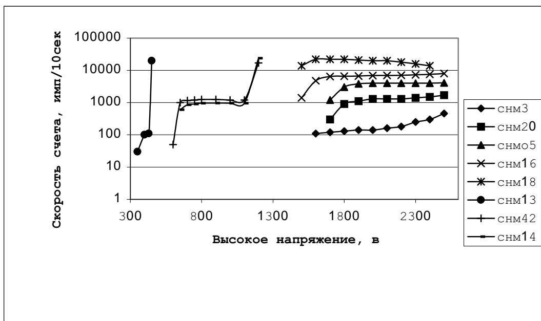
Рис. 3. Счетные характеристики пропорциональных и коронных счетчиков нейтронов.
