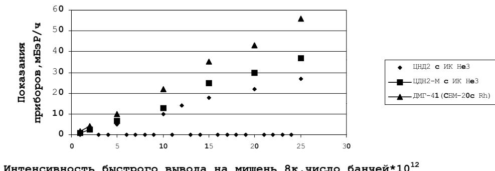
Рис. 8. Отклики различных детекторов в районе мишеннной станции 8-го канала ускорителя У-70 с энергией протонов 70 ГэВ (ДМГ-41 — радиационный монитор АСРК).
