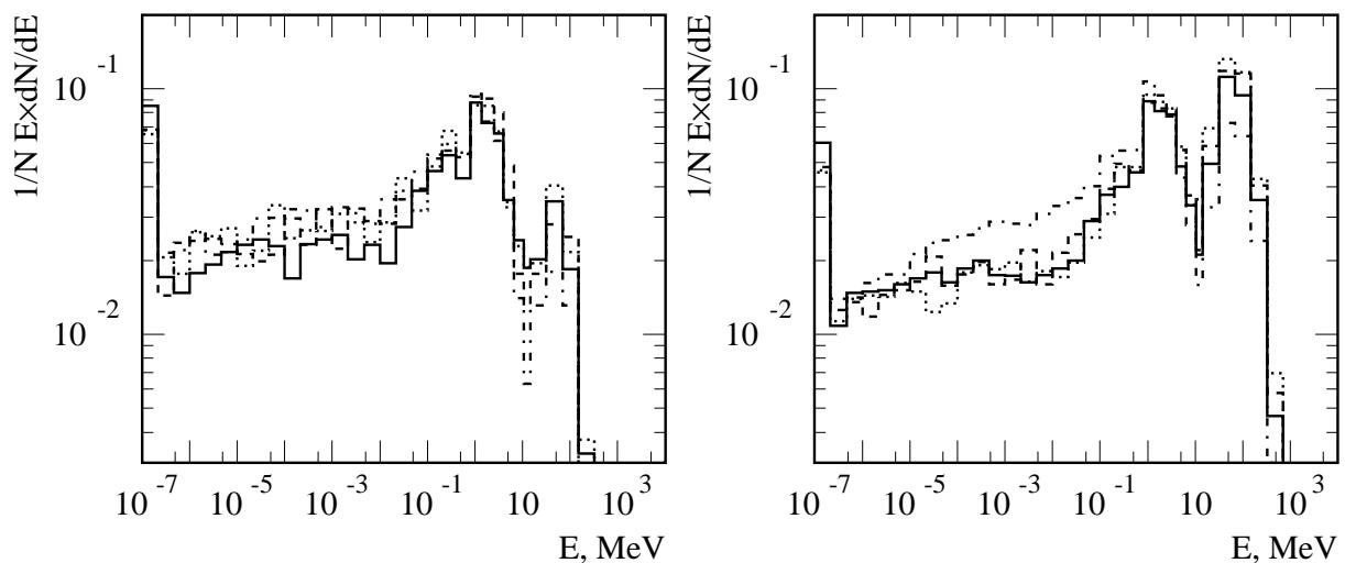
Рис. 7. Сравнение спектров нейтронов на мюонной камере ME4 (слева) и радиусе  $r=3$  м вокруг передней защиты (справа), рассчитанных для четырех исследованных конфигураций защиты (описание конфигураций дано в п.5, обозначения на рисунке те же, что и на рис.6).
