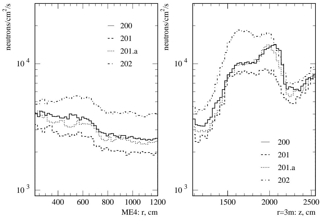
Рис. 6. Сравнение плотностей потоков нейтронов на мюонной камере МЕ4 (слева) и  $r=3$  м вокруг передней защиты (справа) для четырех исследованных конфигураций защиты (описание конфигураций дано в п.5).
