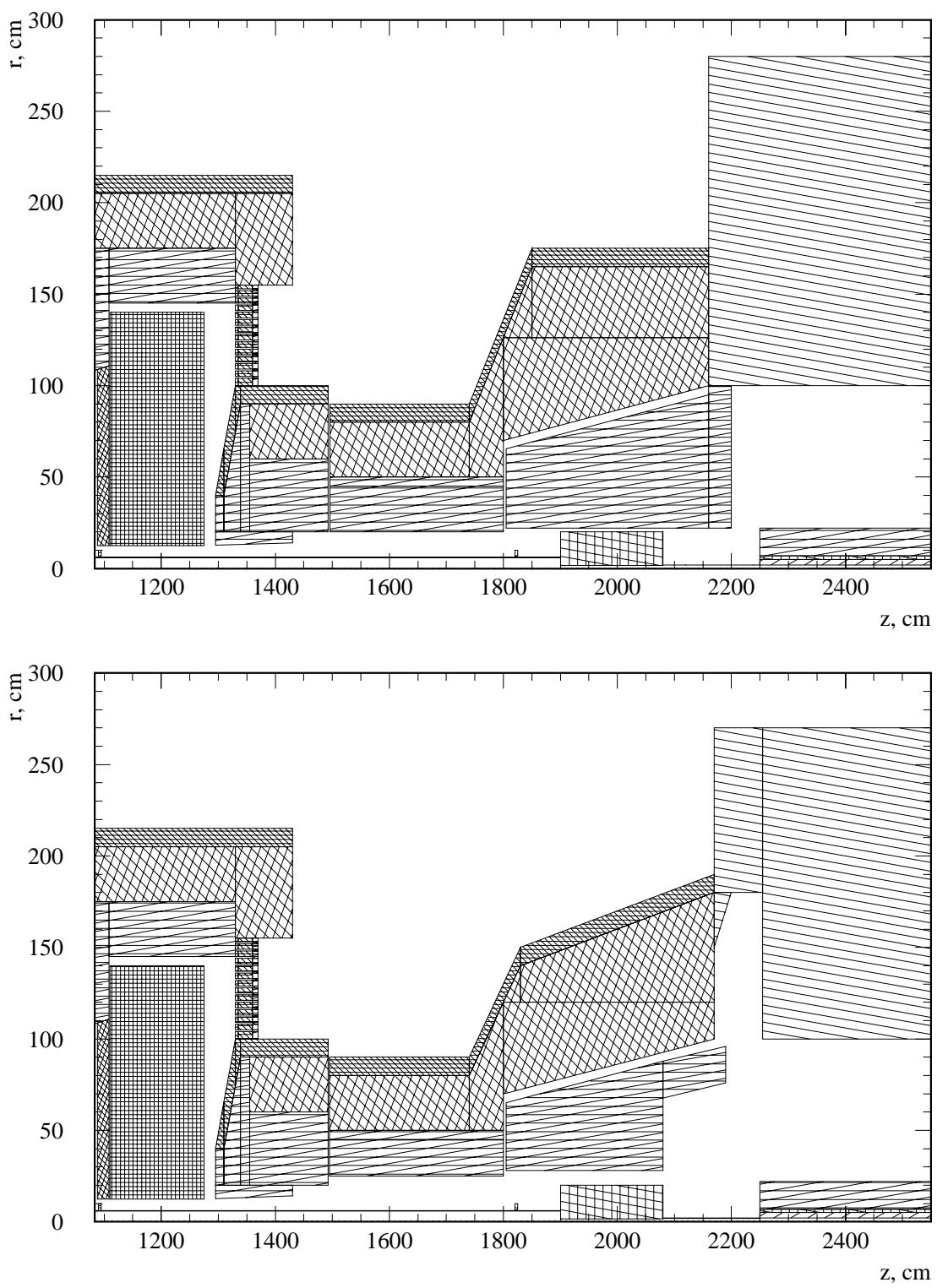
Рис. 4. Конфигурация передней защиты, использованная при расчетах для технического проекта мюонной системы эксперимента CMS (вверху), и модель инженерного проекта передней защиты (внизу).
