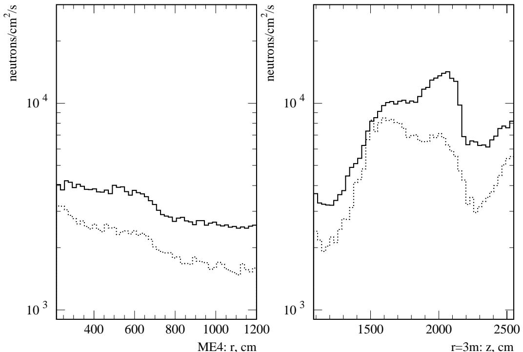
Рис. 5. Сравнение плотностей потоков нейтронов на мюонной камере ME4 (слева) и радиусе  $r=3$  м вокруг передней защиты (справа), рассчитанных для технического проекта мюонной системы (точки) и инженерного проекта передней защиты (сплошная линия).
