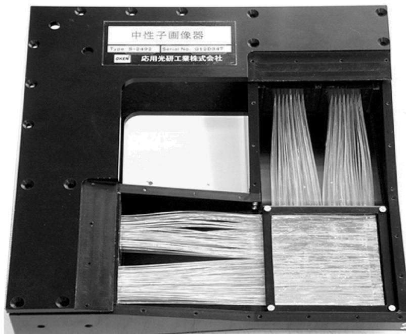
**Рис. 2.** Внешний вид детектора со снятыми крышками.
