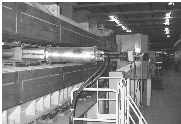
Рис. 11. Станция кристаллических дефлекторов, смонтированная на ускорителе У-70.
