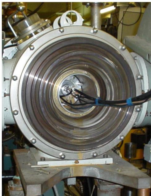
**Рис. 7.** Протонная пушка.
