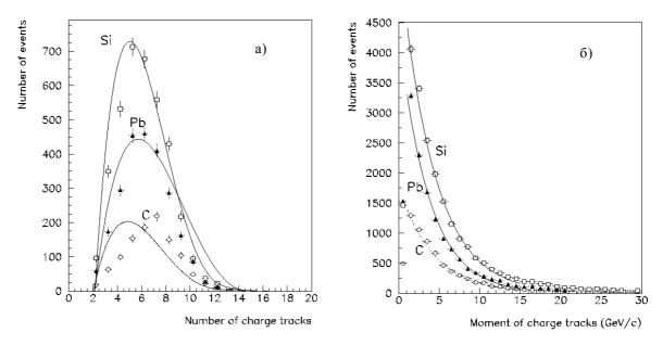
Рис. 9. Сравнение предсказаний программы FRITIOF (сплошная линия) с экспериментальными данными (● – C, ■ – Si, ▲ – Pb): а) распределение по множественности заряженных частиц в первичной вершине; б) импульсное распределение заряженных частиц.
