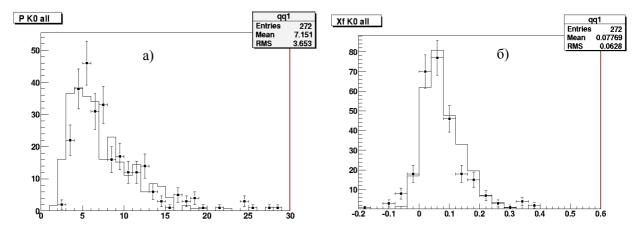
Рис. 13. Распределение по импульсу (а) и переменной Xf (б) восстановленных K<sup>0</sup>s для МК-событий (сплошная линия) и экспериментальных событий (черные точки).
