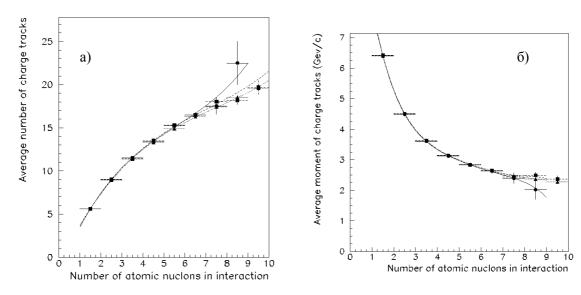
Рис. 4. Зависимость средней множественности заряженных частиц (a) и их среднего импульса (б) от числа участвующих во взаимодействии нуклонов ядра ( $\blacktriangle$  − Pb,  $\blacksquare$  − Si,  $\bullet$  − C).
