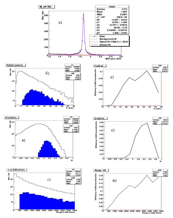
Рис. 15. а) Спектр эффективных масс системы  $(K^+\pi^-)$ ; б) импульс; в)  $X_{\rm f}$  и г) длина пробега восстановленных  $\check{D}^0$  (заштриховано); эффективность регистрации  $\check{D}^0$  в зависимости от импульса (д), Xf (е) и длины пробега (ж).
