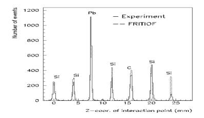
Рис. 8. Координата точки взаимодействия вдоль пучка (мм) для экспериментальных событий (сплошная линия) и МК-событий (штриховая линия).
