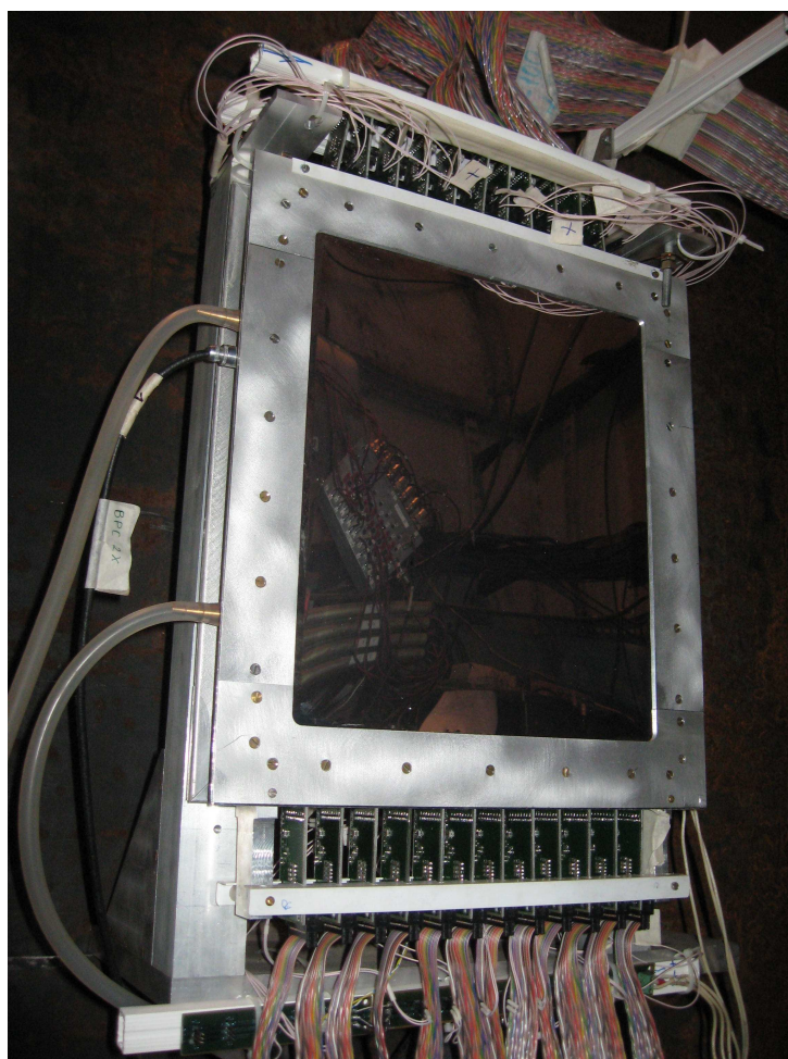
Рис. 3. Фотография пучковой пропорциональной камеры BPC_{2X} .
