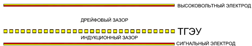
Рис. 1. Структура ТГЭУ. Типичные размеры газовых зазоров – 3 мм и 1 мм для дрейфового и индукционного зазоров соответственно.
