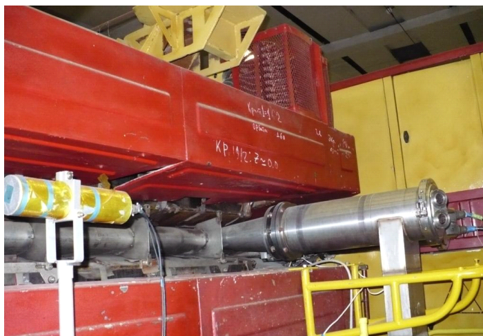
Рис. 1. Общий вид установленной на ускорителе станции с изогнутыми кристаллами.
