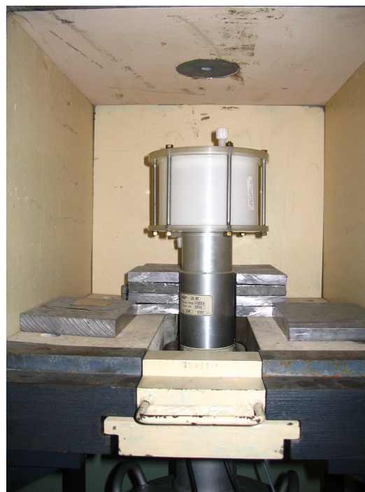
Рис. 3. Сосуд Маринелли в спектрометре.
