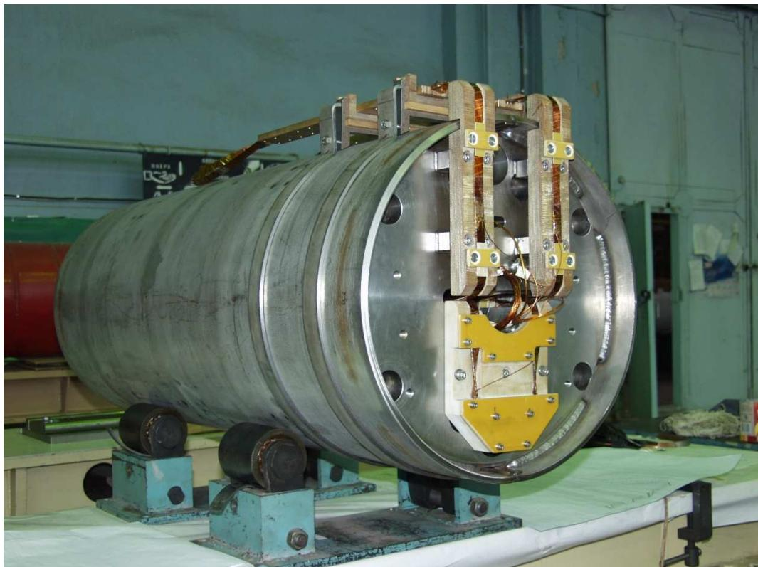
Рис. 2. Сверхпроводящий высокопольный быстроциклирующий дипольный магнит.
