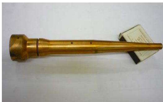
Рис. 3. Нога крепления промежуточного электрода с экранированным сопротивлением.
