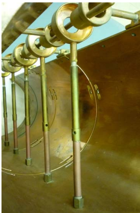
Рис. 2. Нога крепления промежуточного электрода с проволочным сопротивлением.
