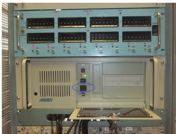
Рис. 9: Промышленный компьютер iROBO-2000 с платами цифрового задающего генератора, установленный в стойку №14 в зале электроники главного пульты У-70.
