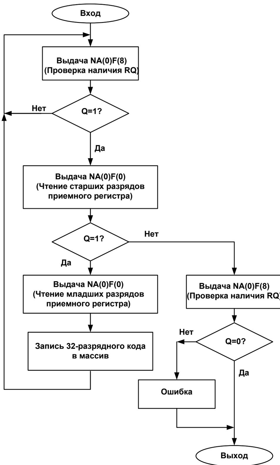
Рис. 8. Алгоритм опроса автономного контроллера через систему СУММА.
