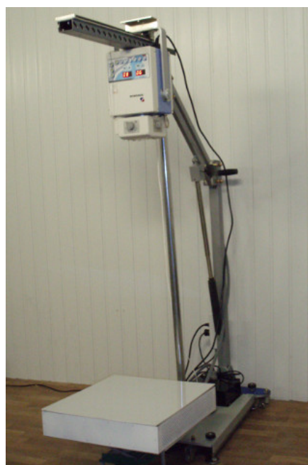
Рис. 6. Измерительный стенд с рентгеновским источником (вверху), движущимся по направляющим синхронно со сканером (внизу).
