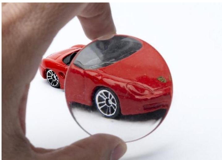
Рис.4 Пример качества прозрачности линзы из фотополимера [6].
