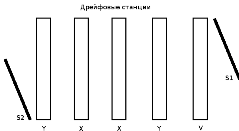
Рис. 20. Схема постановки измерений на наклонном космическом излучении: S_1 и S_2 – сцинтилляционные счетчики; обозначения X, Y соответствуют измеряемой координате, V – указывает на наклонные трубки.
