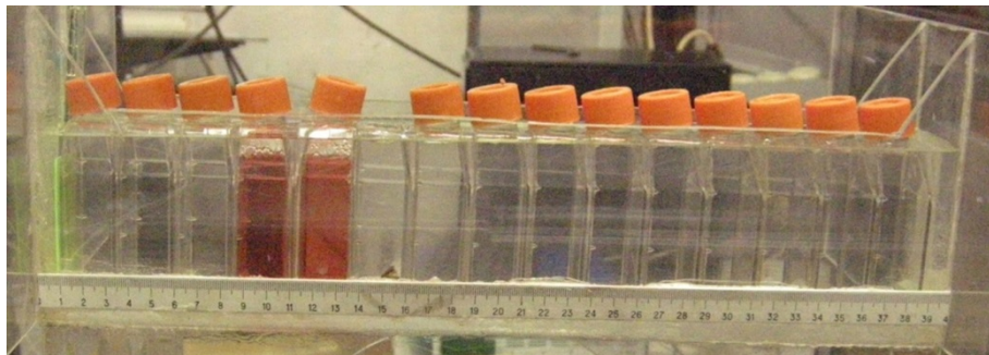
Рис. 8. Малый водный фантом с флаконами с водой и биообъектами. Углеродный пучок движется справа налево.
