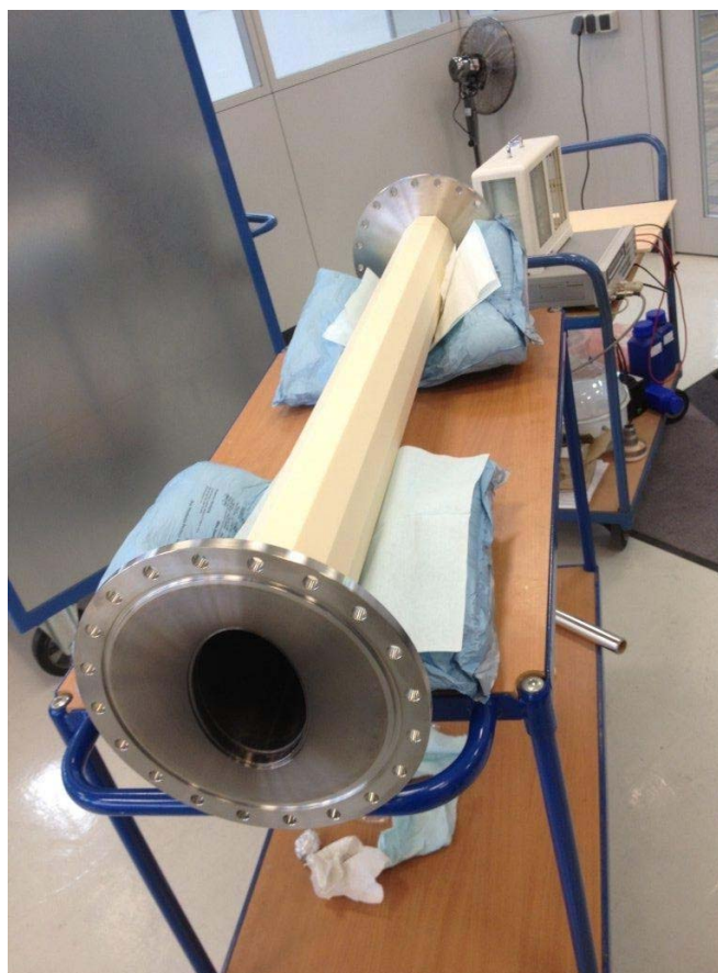
Рис. 5. Металлокерамическая вакуумная камера бамп-магнита.
