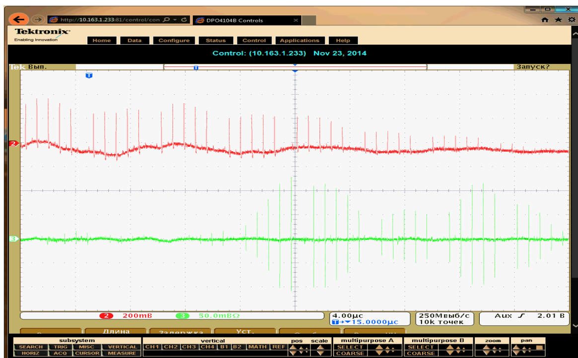
Рис. 13. Осциллограмма сигнала с трансформатора тока пятиоборотного вывода пяти сгустков.
