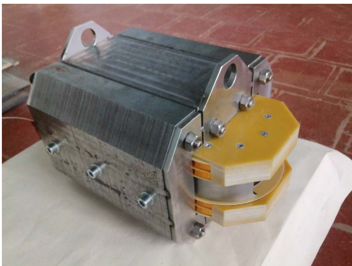
Рис. 11. Общий вид ВТСП дипольного магнита.
