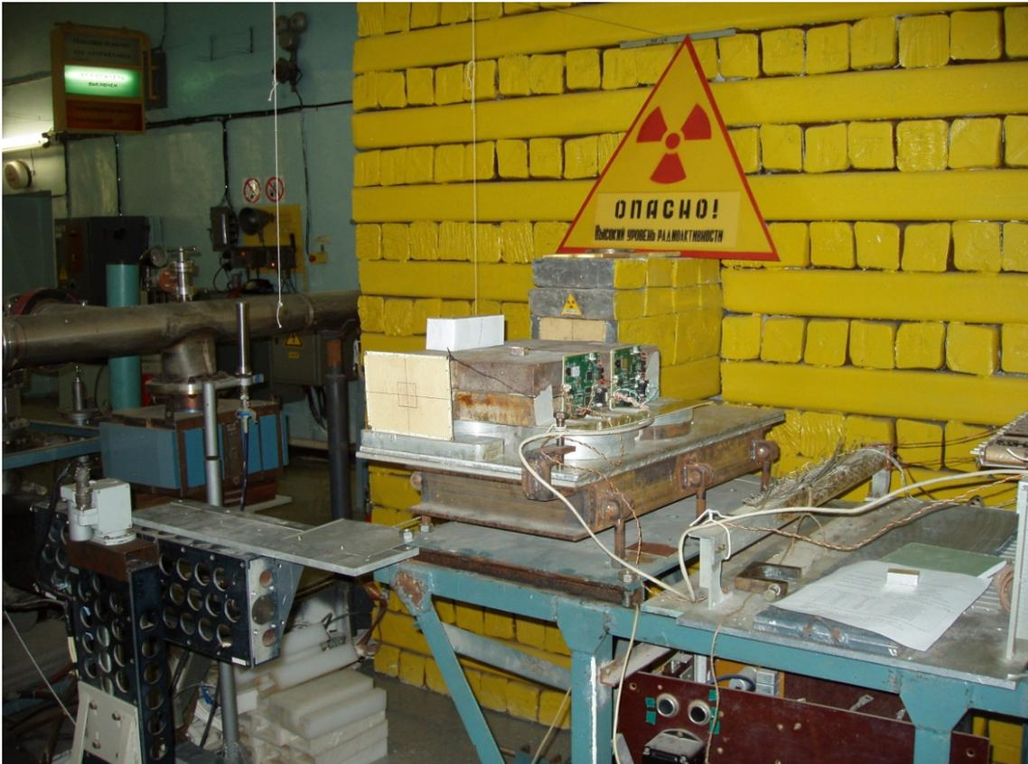
Рис. 1. Вид поглотителя пучка бустера с мишенью из металлических блоков и облучаемых образцов.
