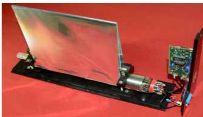
Рис. 4. Вид счетчика с домиком - отражателем из алюминизированного майлара.
