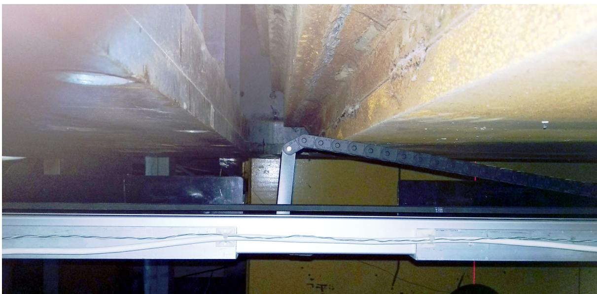
Рис. 5. Фотография системы перемещения. Максимальное верхнее положение определяется размером звена гибкого кабель-канала с управляющей платой.
