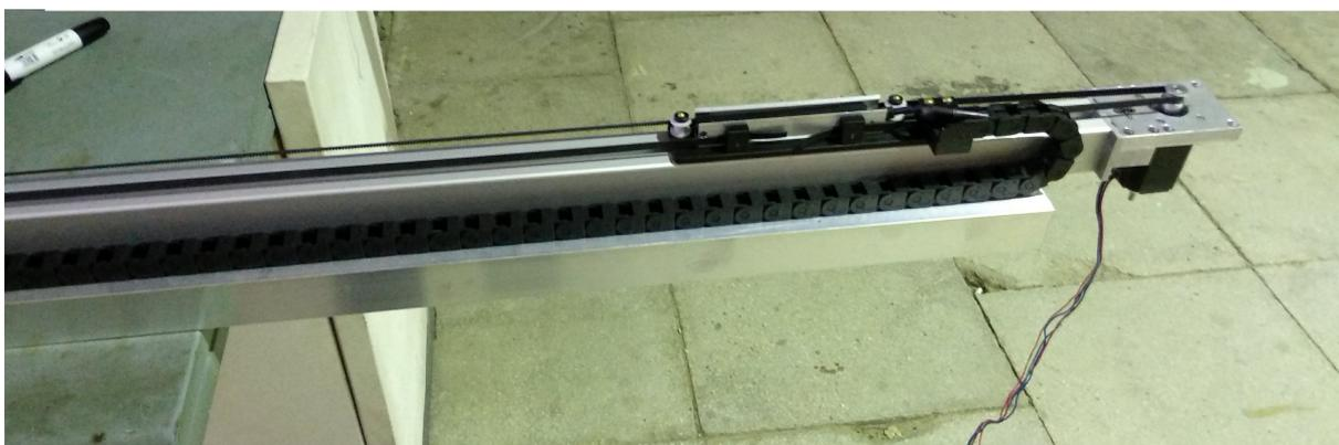
Рис. 1. Фотография системы продольного (параллельно оси пучка) перемещения датчика.
