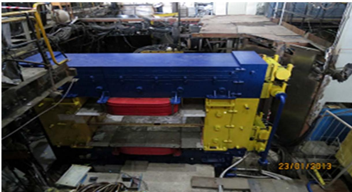
Рис. 1. Фотография спектрометрического магнита М31 на канале №14.
