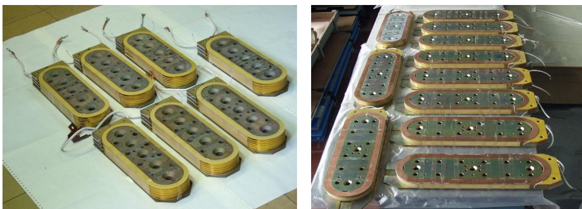
Рис. 2. ВТСП обмотки СПСД (слева) и СПСГ (справа).
