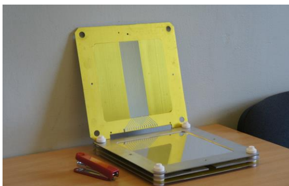
Рис. 1. Камера вторичной эмиссии для измерения профиля пучка.
