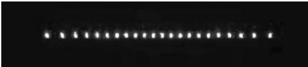
Рис. 8. Ионы  $Yb^+$  (видно по их флуоресценции) в линейной ловушке Пауля. Расстояние между ионами составляет около 10–20 мкм.
