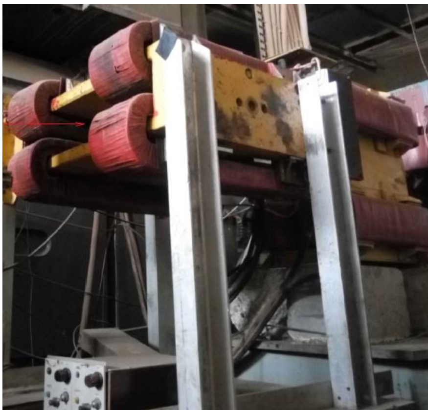
Рис. 9. Общий вид расположения корректирующих магнитов КМ1 и КМ2 на канале № 14 У-70. Стрелка указывает направление движения протонного пучка в канале.
