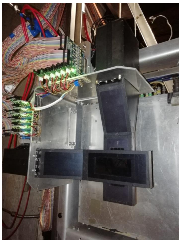
Рис. 4. Фотография сцинтилляционного волоконного годоскопа в составе экспериментальной установки СПАСЧАРМ на канале 14.
