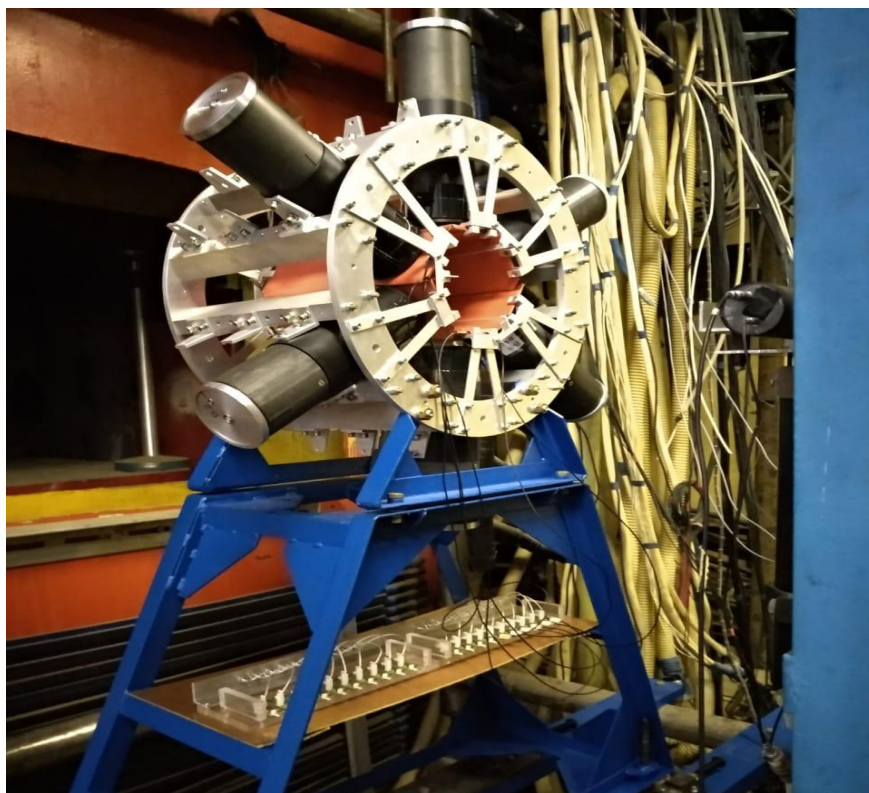
Рис. 7. Общий вид мишенного узла установки Гиперон+ на 18 канале У-70, красным цветом показаны продольные счётчики вето-детектора заряженных частиц. Черные тубусы – сцинтилляционные счетчики на основе кристаллов NaI и BGO. Внизу видна панель с усилителями для SiPM.
