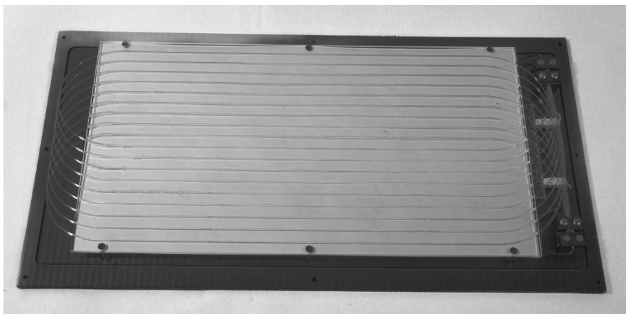
Рис. 10. Фото общего вида счётчика без светоотражающей и светозащитной обёрток: сцинтилляционная пластина с WLS волокнами, двумя SiPM, к которым присоединены торцы волокон и электронным модулем.
