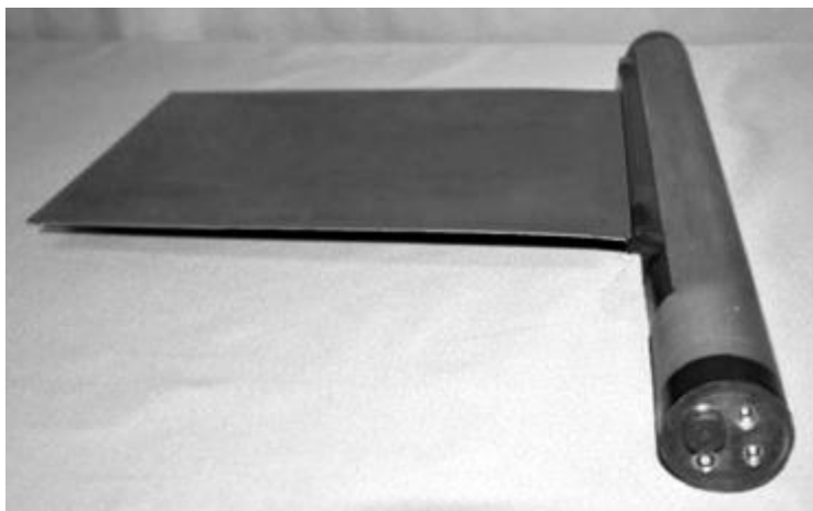
Рис. 2. Фото общего вида тонкого сцинтилляционного счётчика с размерами рабочей области сцинтиллятора 1 \times 200 \times 300 мм 3 .
