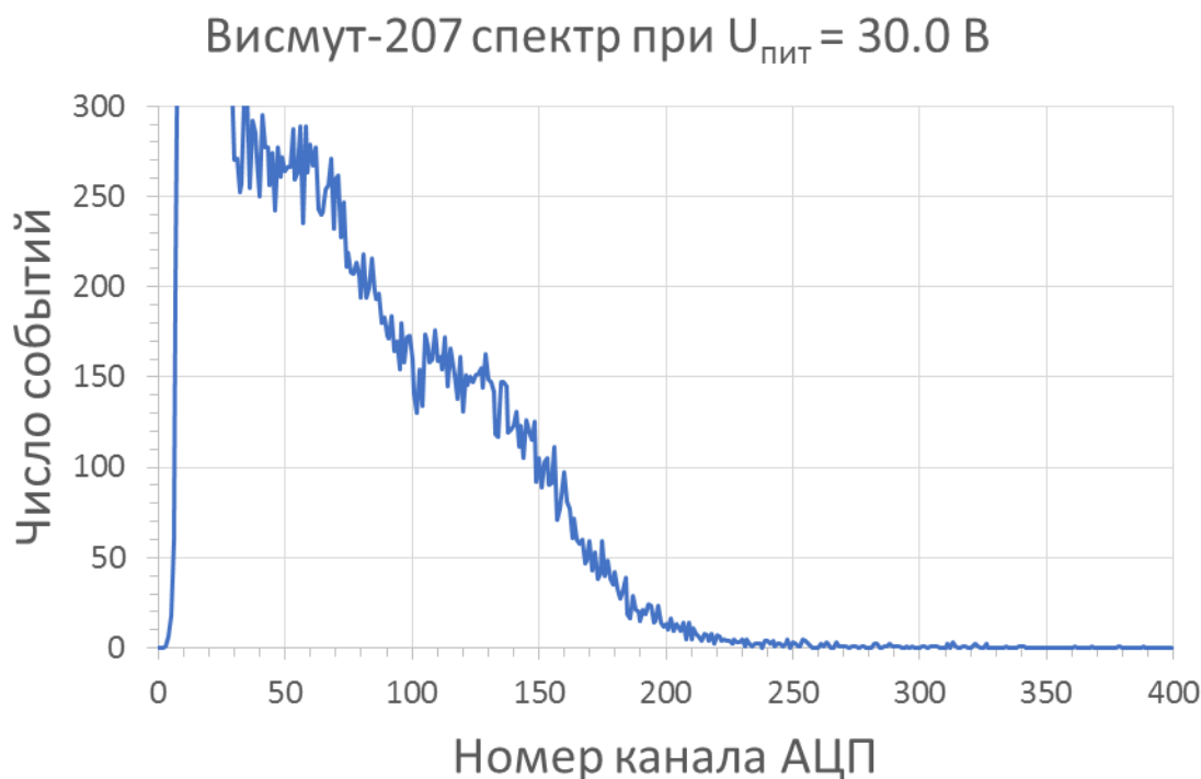
Рис. 15. Амплитудный спектр суммы сигналов обоих SiPM при регистрации излучения от источника ^{207}\text{Bi} с пластмассовым фильтром толщиной 1 мм.
