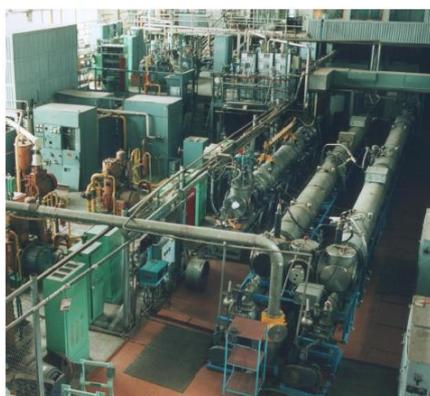
Рис. 13 Стенд для испытания СП магнитов УНК (ИФВЭ) [43].
