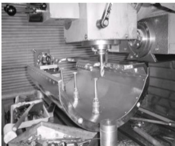
Рис. 19. Монтаж ускоряющих электродов непосредственно на станке.
