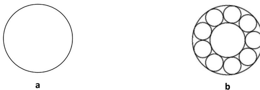
Рис. 4. Проводник с поперечным сечением в вид круга, **SHAPE** = 21 (a). Полый проводник нуклотроновского типа, **SHAPE** = 22 (b).
