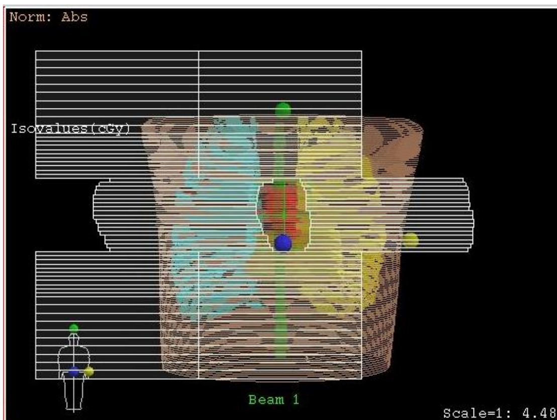
Рис. 7. Тестовый план облучения для МЛК с переменной шириной лепестка в системе планирования XiO Eclipse 4.64 для фотонного пучка (цвета в онлайн-версии).
