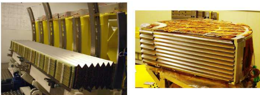
Рис.4.4. Фотографии секторов барреля (справа) и торцевого (слева) EM калориметра детектора ATLAS. Ось пучка на левом снимке направлена вверх. На правом снимке видны семь структур механической поддержки конструкции калориметра.
