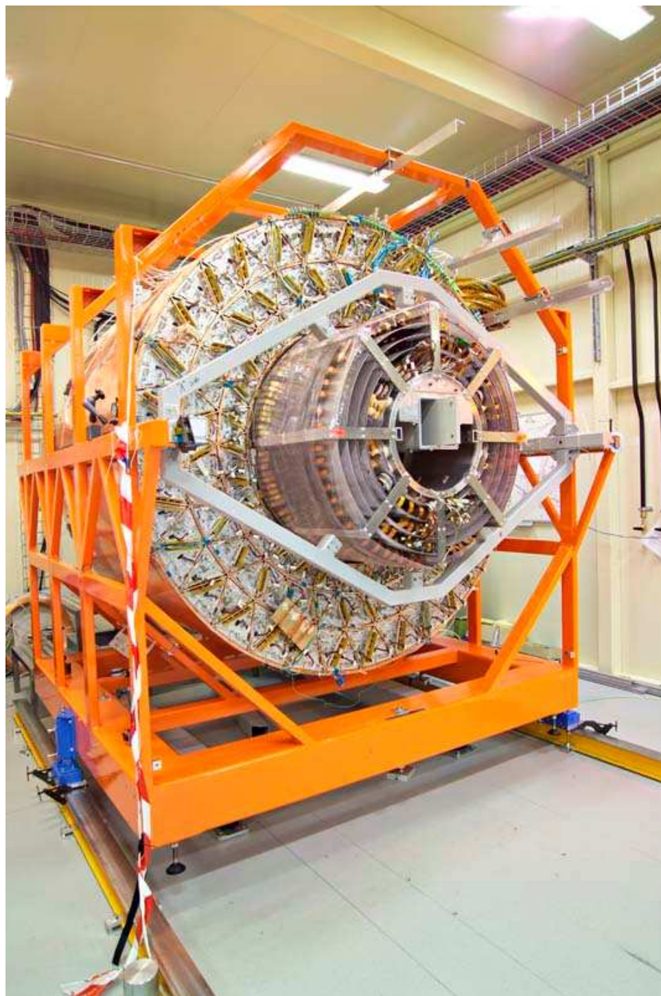
Рис.3.16. Центральная часть Детектора переходного излучения и SCT детектора ATLAS в сборке.
